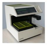
Fig. 1: Kontron 460/465 autosampler
